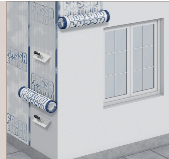
annegare la rete nella rasatura di collante FASSA A 96
