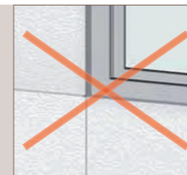
giunti in corrispondenza delle aperture
